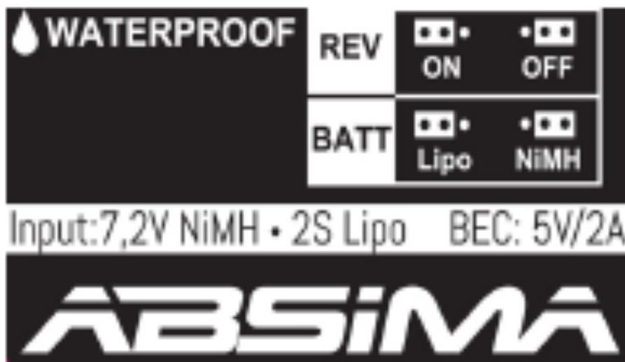
Le contrôleur peut être utilisé avec des piles NiMH et LiPo. Pour le mettre en place, vous devez repositionner le petit bouchon noir sur le contrôleur. Pour LiPo le bouchon tout le chemin vers la gauche et la fiche pour NiMH extrême droite. Le sens de rotation peut être modifié avec les bouchons (fonctionne comme avec la batterie).
